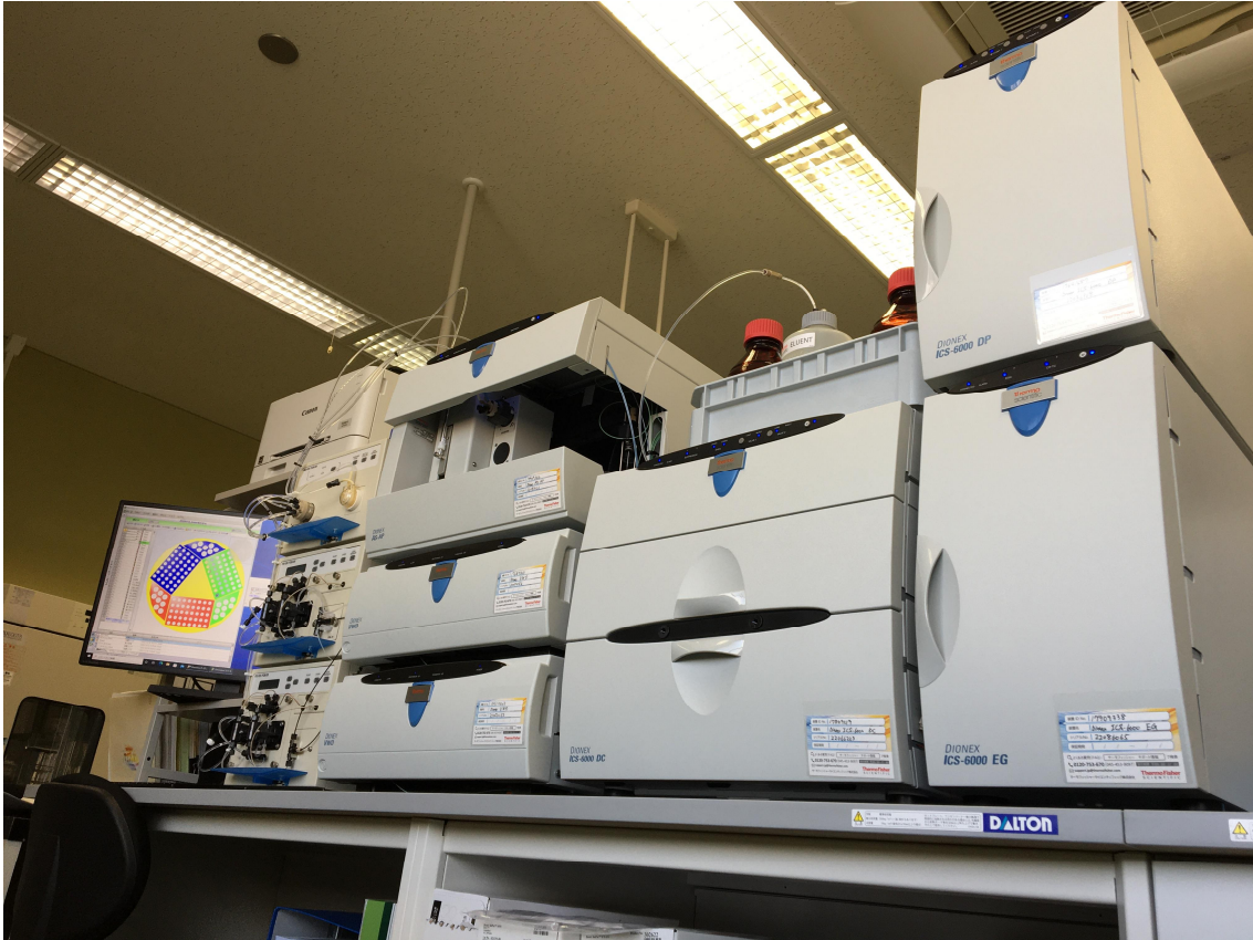
イオンクロマトグラフ分析装置及びホストラム吸光光度分析装置
